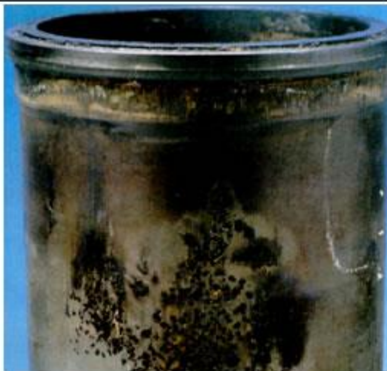
Figura 1. Zona erosionada por cavitación
